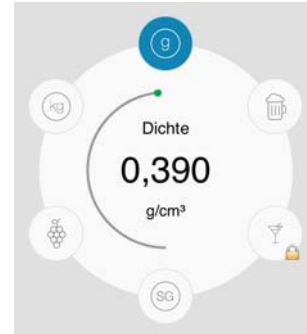
Abb. 9-3: Messfortschritt durch einen Bogen angezeigt
